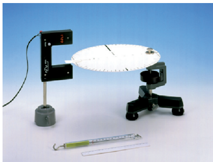
Рис. 2. Внешний вид лабораторной установки «Момент инерции, теорема Штейнера» фирмы RHYWE, входящей в состав лабораторного практикума по физике.
